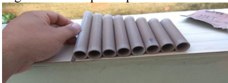
Figura 3.11: Esquema para colar os canos
