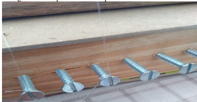
Figura 1.5: Esquema de como passar a corda do outro lado
